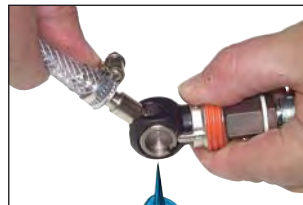
Kupplung ausschwenken - Kupplung schließt und entlüftet
